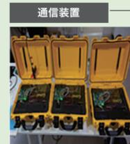
携帯通信網を利用した安定的な通信環境で水位情報などをリアルタイムで伝送(LPWAなどのその他通信技術も対応可)
