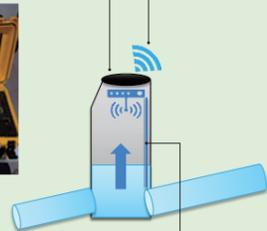
管内での設置作業が不要なため短時間で設置ができる(マンホール内作業は必要)
