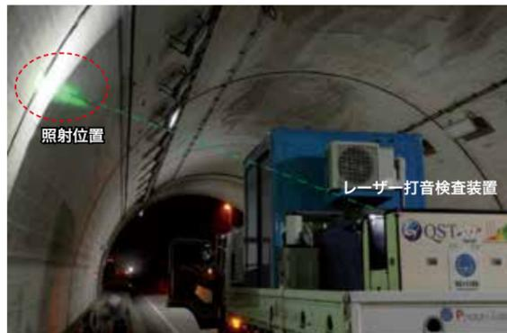
レーザー打音による検査
