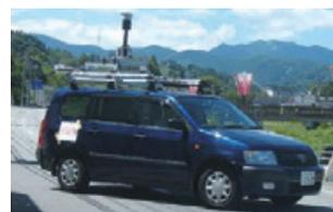
車載3次元高精度カメラ
