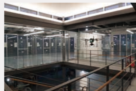
屋内外自律飛行システム「BIM×Drone」 （画像提供：株式会社竹中工務店） BIM × Drone Autonomous Indoor Flying System （Picture Provided by Takenaka Corporation）
