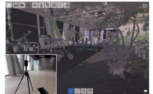
3D空間点群スキャナによる計測と計測画面
