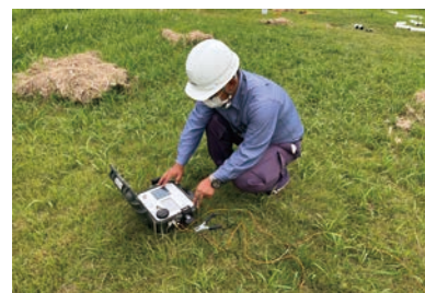
3次元電気探査の現地調査の様子。使用している機材はグループ企業IRIS社が開発した電気探査装置「V-FullWaver」
