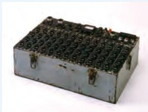
1957 真空管式地震探査装置開発
