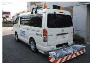
路面下空洞探査サービス
