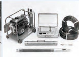
1972 高圧孔内水平載荷試験装置
