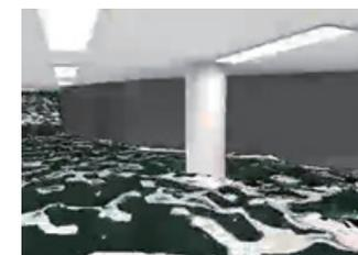
施設内浸水対策効果シミュレーション (地下鉄駅構内)
