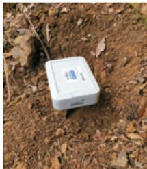
傾斜変動検知センサ
