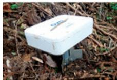
IoT傾斜センサ「クリノポール」
