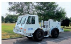
パイプレータ型掘削車を用いて地盤に振動を与え、地表から地下1,000mまでの地質構造を明らかにする深部地質構造探査車「エンパイロバウ」
