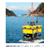
層変形モニタリングシステムの海底設置型装置
