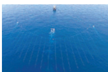
メタンハイドレートなど次世代の資源探査にも活用が期待されている高分解能三次元海上反射法探査システムP-Cable (NCS Subsea社)
