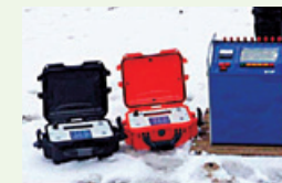
Fullwaverシステム (青:電流送信装置、赤:電流送信制御装置、黒:受信装置)
