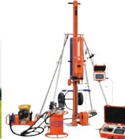
液状化判定装置 「ピエゾドライブコーン」
