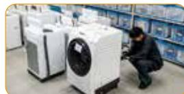
1次、2次点検の工程を経て最終確認を行い、付属品などを取り付けて出荷します。
