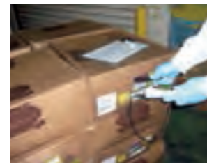
入荷された食材の温度を測定して基準内であることを確認(東京工場)
