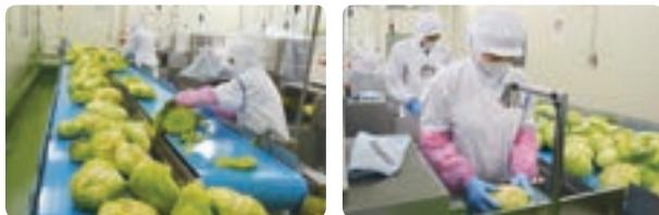
餃子の餡に不可欠なキャベツの下処理加工として、キャベツの作業ラインへの投入、外葉や芯の除去、検品、清掃を行います。久御山工場では、一日に餃子約120万個分のキャベツを処理しています。
