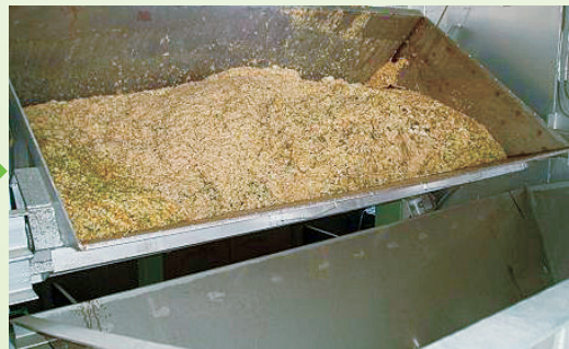
回収した食品廃棄物を発酵・分解
