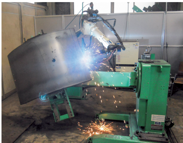
セグメント溶接ロボット
